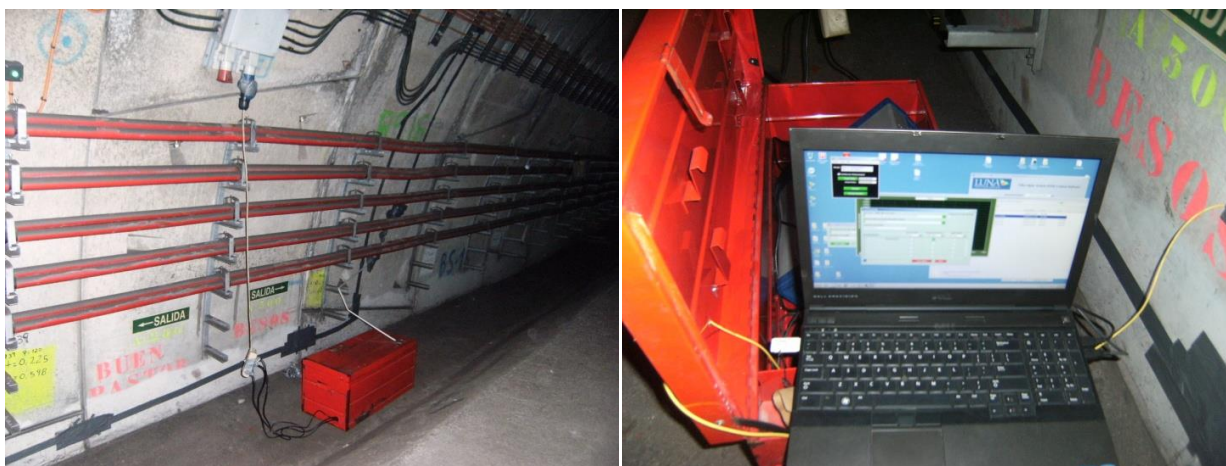
Figura 8. Carretel de fibra ótica restante sujeito à estrutura e ODiSI (Optical Distributed Sensor Interrogator, da LUNA Technologies, Modelo A50) em operação.
