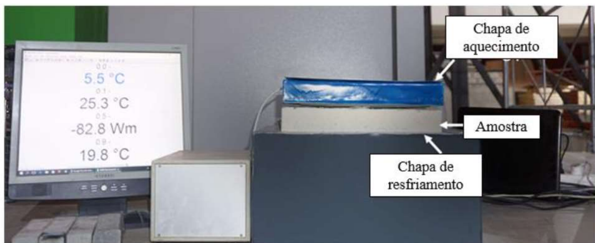
Fig. 2. Configuração do ensaio de condutividade térmica.
