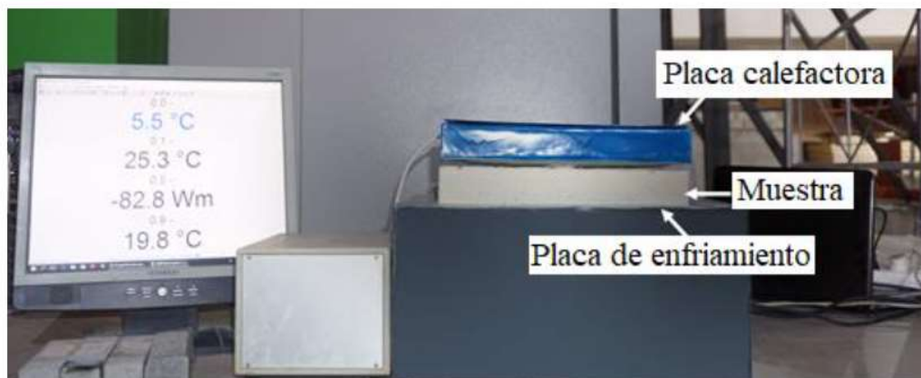
Figura 2. Configuración de la prueba de conductividad térmica.
