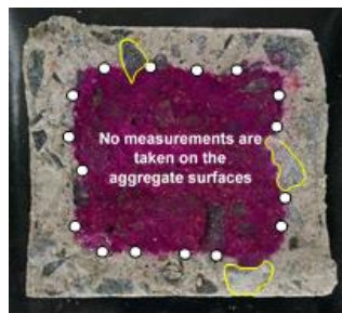
Superficie de fractura a través de muestras de 100 × 100 × 500 mm
