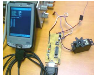
Fig. 9. iPAQ hx2490b con Windows Mobile 5.0 y prototipo modificado (PIC16F628).
