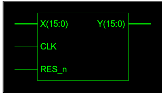
Fig. 4. Entidad de un filtro Fir en FPGA XILINX
