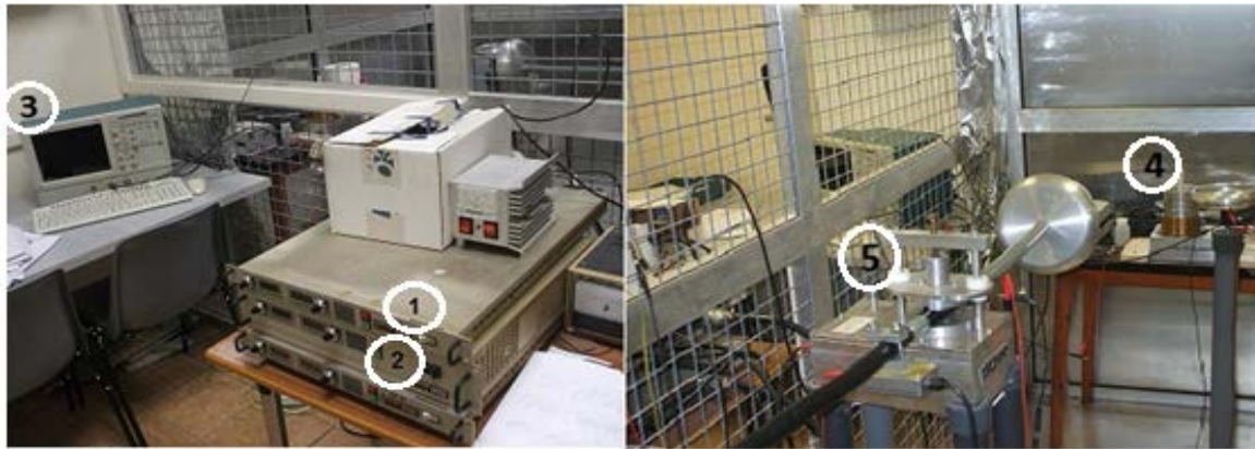
Figura 3. Técnica PEA. (1) Fuentes de alimentación de alto voltaje modulares Spellman SL80PN10/10001 0 - 80kV DC para polarización de las muestras; (2) Fuentes de alimentación de alto voltaje modulares Spellman SL6PN600/10007 0 - 5kV DC para el generador de pulsos; (3) Osciloscopio digital Tektronix TDS 5032; (4) Célula de medidas para muestras planas; (5) Célula de medidas para cables.
