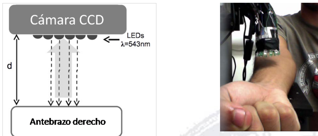
Figura 1. a) Esquema experimental y b) Esquema experimental y antebrazo del voluntario.
