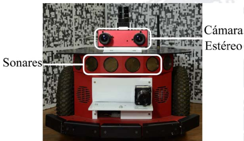
Figura 1: Agente artificial: Robot Pioneer 3-DX con un arreglo de sonares y una cámara estéreo en el frente
