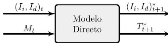
Figura 3: Esquema del modelo directo propuesto . La entrada está compuesta por las imágenes izquierda y derecha (I_i, I_d) y el comando motriz (M) al tiempo t . La salida está compuesta por la predicción de las imágenes izquierda y derecha (I_i, I_d)^* y el estado táctil (T)^* al tiempo t + 1 .
