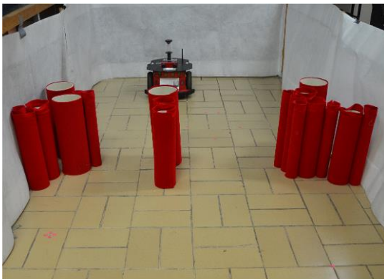
Figura 13: Ambiente para el estudio del concepto de pasabilidad . El agente se encuentra situado frente a una escena visual que muestra dos aperturas, según la imagen por la de la izquierda el agente no puede pasar mientras que por la de la derecha sí.
