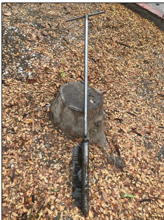
FIGURA 3. Barreno ruso / Toma de muestra con barreno ruso.
