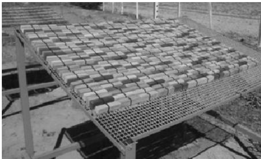
FIGURA 1. Amostras de madeira submetidas ao intemperismo natural.
