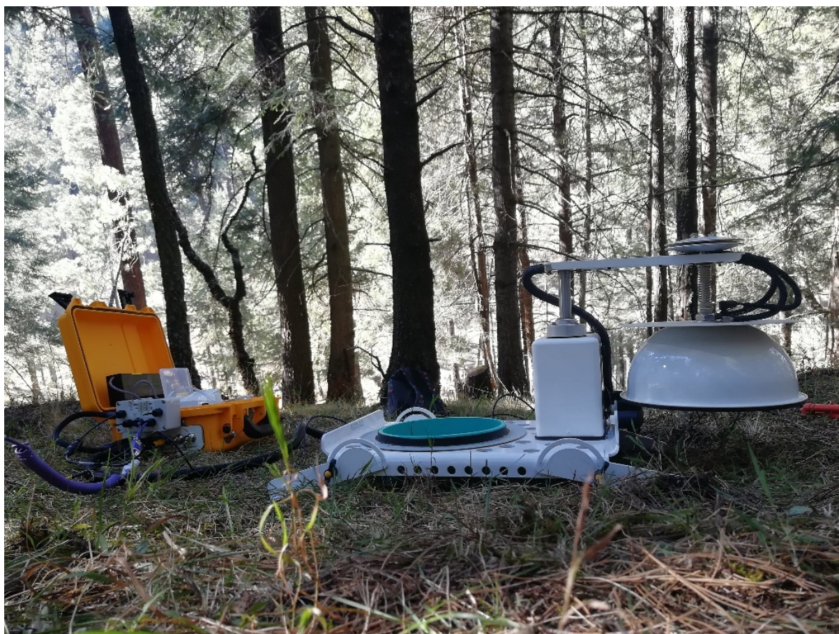
FIGURA 2. Medición de R_s con equipo LI-COR en la Estación Forestal Experimental Zoquiapan (EFEZ), dentro del parque nacional Iztaccíhuatl-Popocatepetl, Estado de México, México
