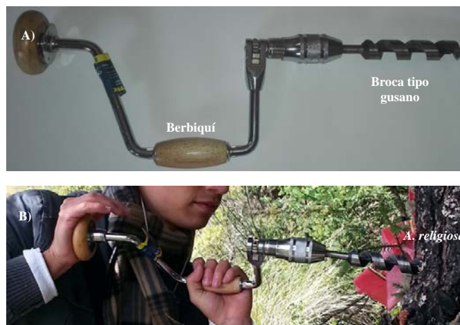
FIGURA 2. Equipo de extracción de madera (A) y toma de muestras de madera de A. religiosa en campo (B).
