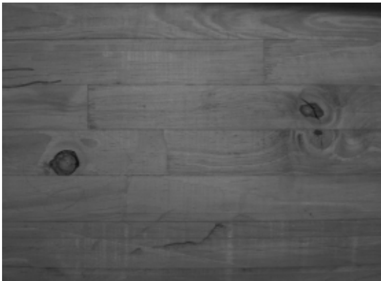
Figura 5. Apreciación visual y técnica de la cantidad y tamaño de los nudos en las láminas de madera que conforman una de las vigas laminadas realizadas con la técnica de finger joint . Se puede apreciar el mal uso de esta técnica al quedar, en este caso de estudio, las uniones muy cercanas entre sí, lo cual ocasiona la falla y una menor resistencia del elemento laminado al momento del ensayo. (Foto: Wilver Contreras Miranda)
