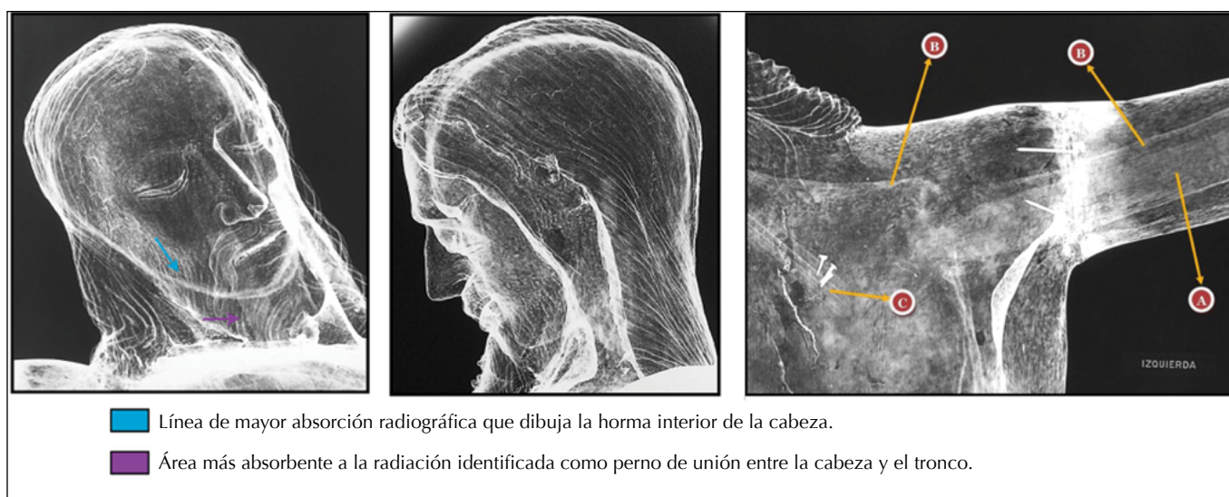
FIGURA 13. Cristo de la buena muerte de Gran Canaria , rayos X de la cabeza en frente y perfil, y detalle de la unión del brazo al cuerpo (Cortesía: Francisco Pablo Amador Marrero, 1999).
