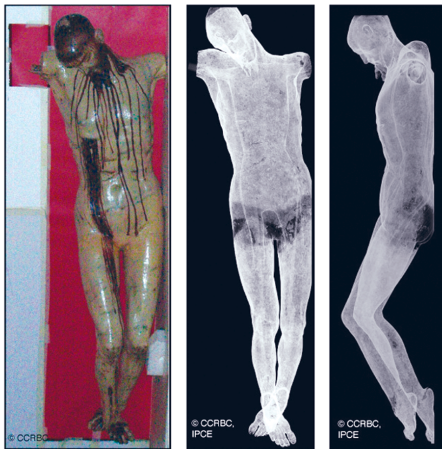
FIGURA 5. Cristo crucificado de Lerma , imagen visible y con rayos X tanto de frente como de perfil con película de rollo continuo (Cortesía: CCRBC-JCyL e IPCE, 2011).
