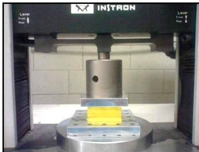
Figura 3.1. Prueba de compresión a materiales hiperelásticos.
