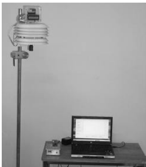
Figura 10. Unidad remota y local del medidor de nivel ultrasónico en laboratorio
