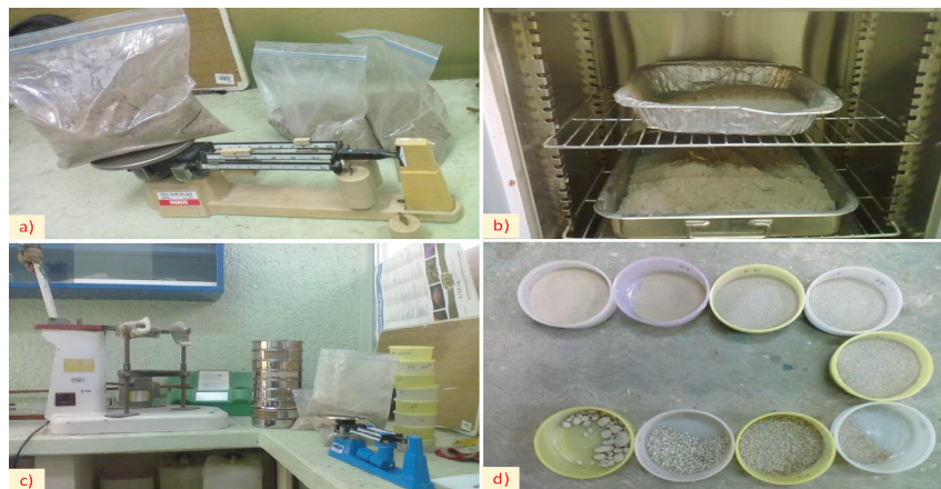
Figura 2. Actividades de laboratorio: a) pesado, b) secado, c) tamizado y d) separación de tamaños
