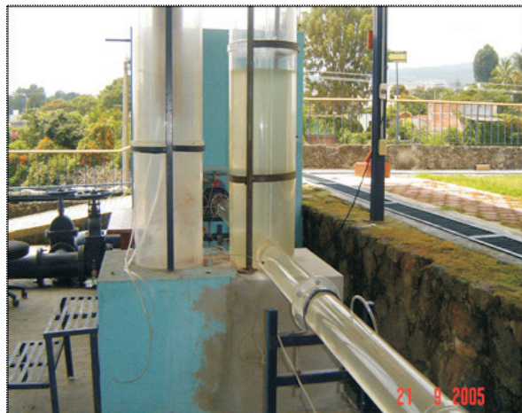
Figura 6. Fluctuaciones de presión con pozo de oscilación simple en la conducción
