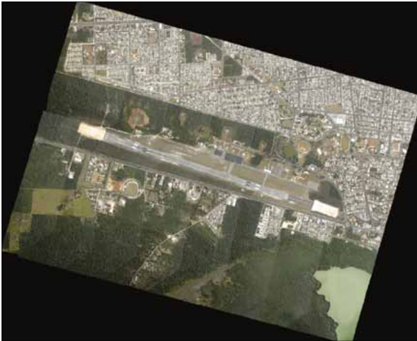
Figura 6. Mosaico ortorectificado, obtenido a partir de imágenes del vuelo bajo del Aeropuerto de Chetumal, Quintana Roo, compuesto de 32 fotografías aéreas digitales.
