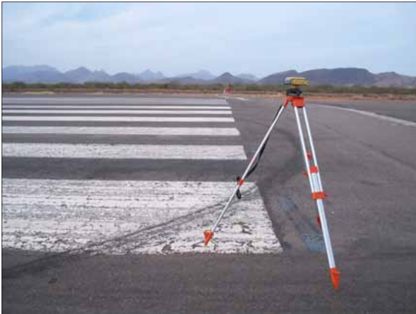
Figura 8. Obtención de puntos de control terrestre sobre las pistas de los aeródromos, con receptores satelitales geodésicos.
