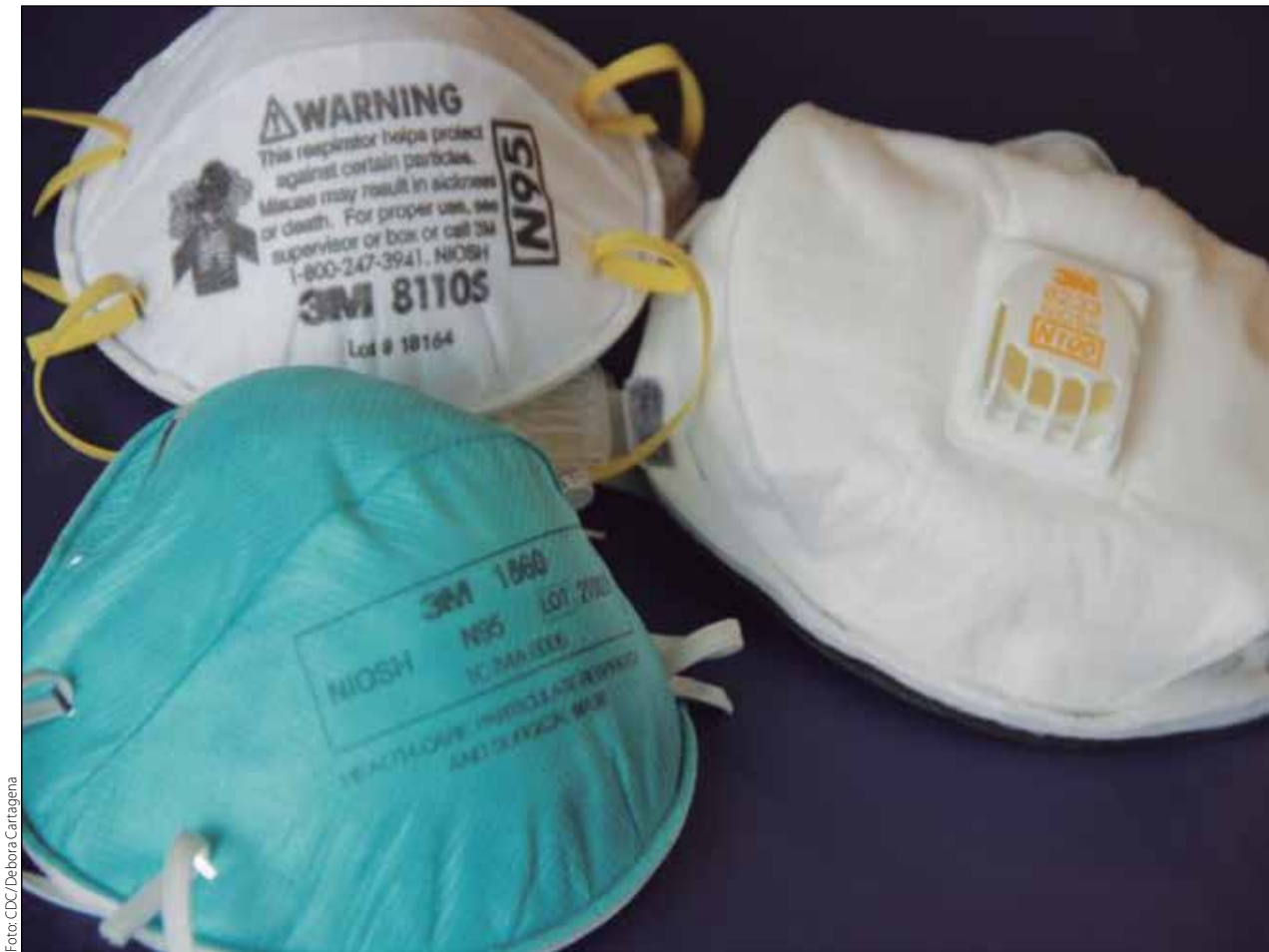
Figura 2. La imagen muestra 2 modelos de respiradores o filtros N95, ambos con capacidad de retención de virus y otros agentes infecciosos. En el lado derecho un respirador N100 en color blanco que muestra una área amarilla, la válvula de exhalación cool flow , útil para una mejor respiración en relación a los presentados en lado izquierdo. Todos estos contarán con certificación en su eficiencia por una agencia de certificación (por ejemplo, el National Institute for Occupational Safety and Health [NIOSH]).
