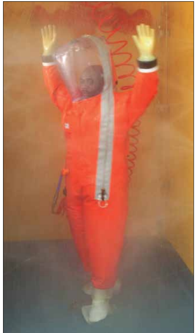
Figura 7. Proceso de descontaminación con solución al 5% de Microchem (producto comercial) en el laboratorio BSL-4 del CDC en los Estados Unidos.
