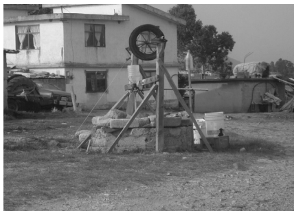
Figura 8. Una rueda en forma de polea con manivela para extraer agua de un pozo, en el ejido El Hospital
