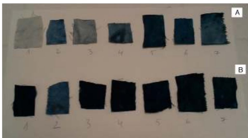
Figura 5 Series de telas teñidas con el leucoíndigo obtenido mediante los procedimientos A (arriba) y B (abajo).
