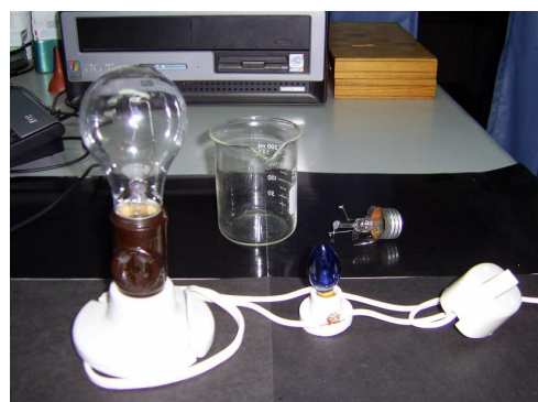
Figura 5. a) Diagrama del dispositivo eléctrico para la síntesis de \text{WO}_3 a partir de un foco estándar; b) El dispositivo eléctrico antes de efectuar la reacción.
