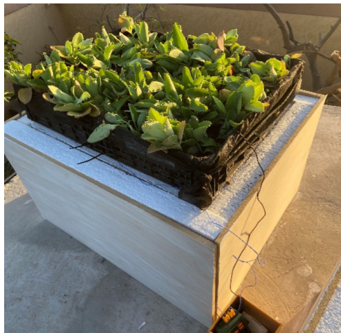
Figura 5. Construcción del prototipo de techo verde
