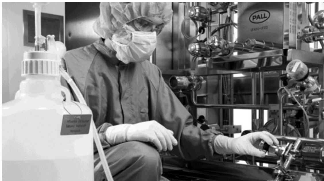
Conducción de la vacuna A (H1N1) del dosificador a la unidad de ultrafiltración
