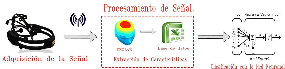
Fig. 2. El sistema consiste de tres módulos: Adquisición, Procesamiento, y Clasificación de señales
