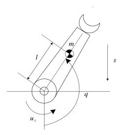
Fig. 1. A pendulum
