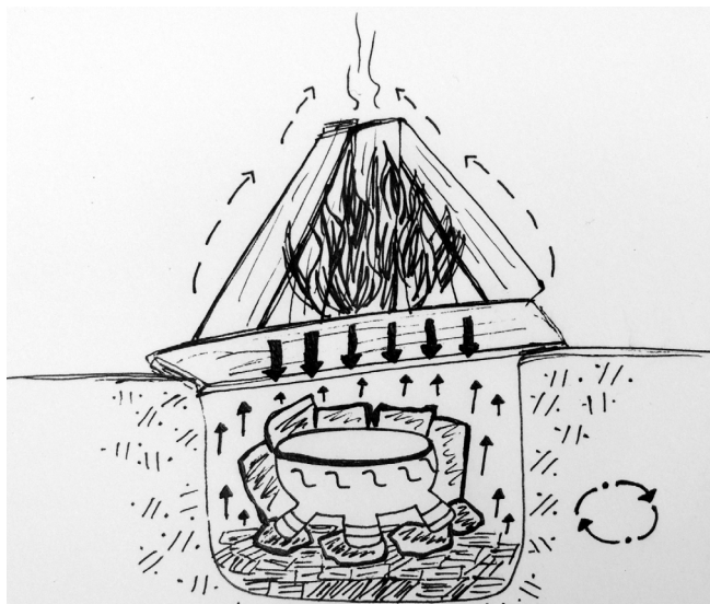
Ilustración 1. Representación de los flujos de calor en un horno efímero de pozo y pira.
