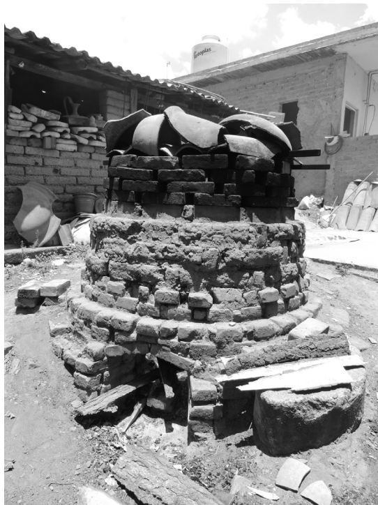
Foto 6. Horno de tipo español empleado por los artesanos de Zinapécuaro, Michoacán. Fuente: Mónica Sosa, 2004.
