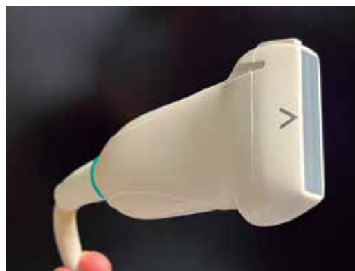
Figura 1: Transductor lineal portátil ( Lumify Phillips ). El transductor y el procesador están contenidos en el dispositivo, la imagen se genera al conectarlo a una tableta o a un teléfono inteligente.
