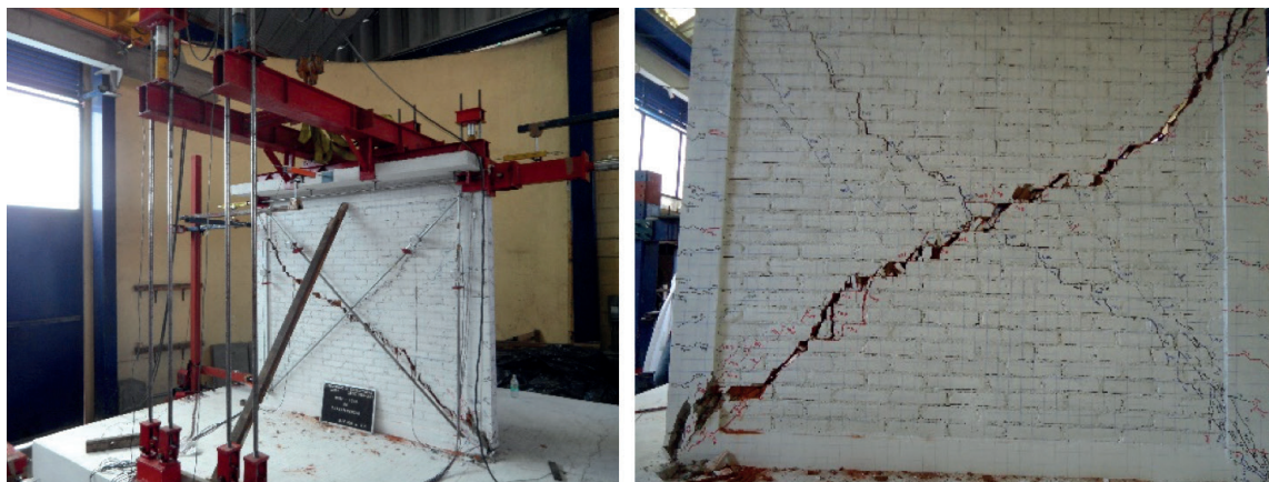
Fig. 21. Agrietamiento final del espécimen ensayado.
