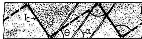
a) Armadura con tensores de concreto.
