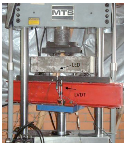
Fig. 3. Dispositivo para la prueba de flexión y tenacidad.
