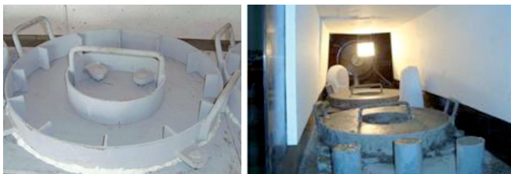
Fig. 1. Anillo y equipo de la prueba de contracción plástica.
