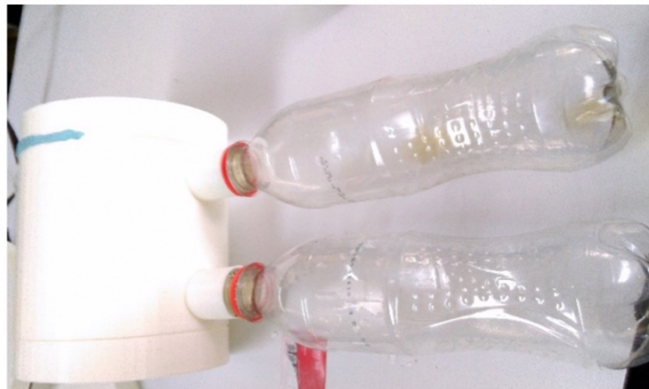
Figura 4. Prototipo nivel laboratorio del calentador solar realizado con impresión 3D. Fuente: Elaboración propia.
