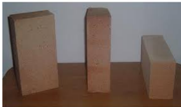
Figura 2. Ladrillo común 7 cm × 12 cm × 28 cm. Fuente: Elaboración propia.
