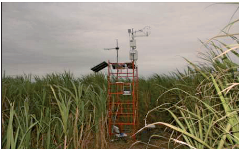
Figura 1. Sensores del sistema de covarianza eddy sobre el dosel de un cultivo de caña de azúcar para medir el flujo de calor (H), vapor de agua (LE) y CO 2 (FCO 2 ) entre el dosel del cultivo y la atmósfera, Xicoténcatl, Tamaulipas, México.
