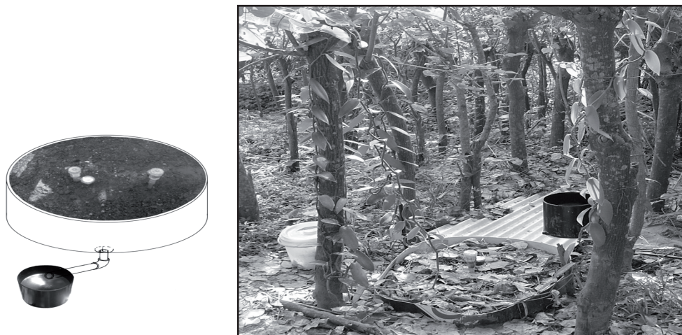
Figura 1. Esquema del lisímetro de balance.
