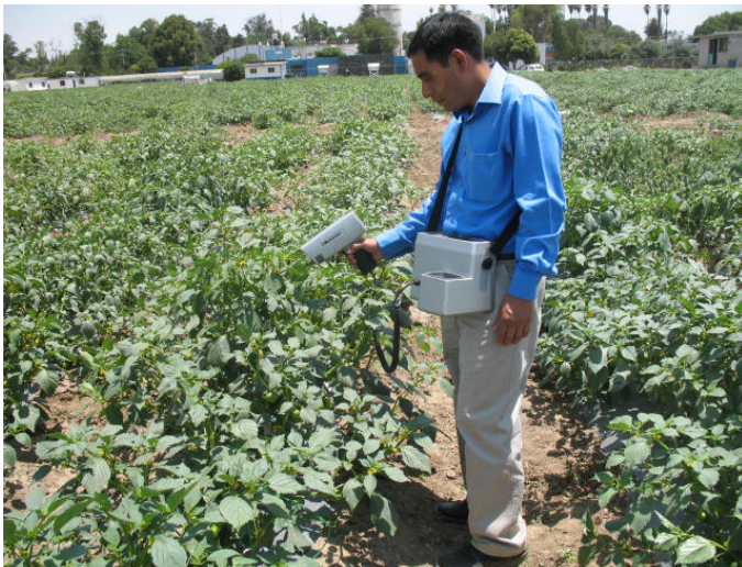
Figura 2. Medición de los parámetros en el cálculo del índice de estrés hídrico con termómetro de rayos infrarrojos en tomate de cáscara ( Physalis ixocarpa Brot).
