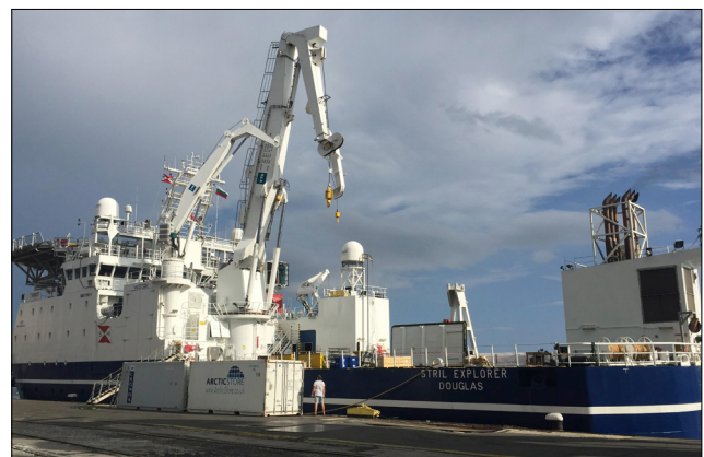
Figura 6. Los contenedores con los laboratorios modular de conservación y análisis de sedimentos del Black Sea MAP siendo montados en la cubierta de MPSV Stril Explorer.
