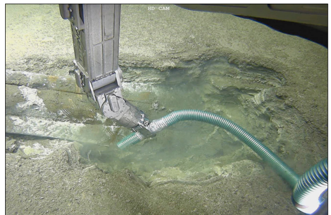
Figura 15. Visualización detallada de la operación en tiempo real de una excavación robótica en el mar Negro a una profundidad de 2 122 metros: a) demostración del uso del brazo kinesiológico (mano derecha del piloto) desde el centro de comando en el buque investigación y b) el manipulador robótico de titanio TITAN4 recibiendo el movimiento preciso del operador por medio de fibra óptica el cual opera la draga de excavación a más de 2 000 m de profundidad.
