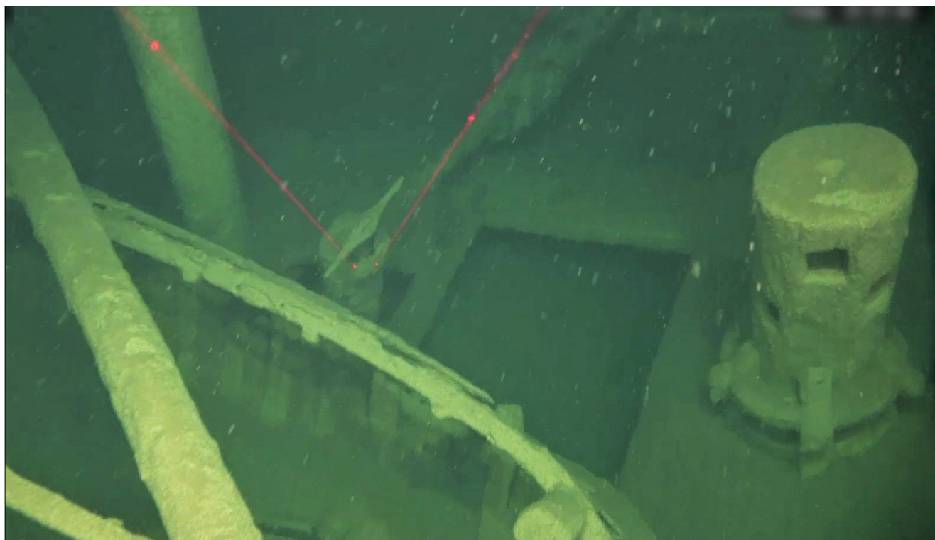
Figura 22. Vista superior de la cubierta principal en donde se logra apreciar la lancha de cubierta en primer plano, a la derecha el cabrestante de madera, la bomba de la sentina apuntada por las guías laser del ROV y, al fondo de la imagen, uno de los pedreros de hierro aun a través de la porta de la borda de estribor en la cubierta principal.
