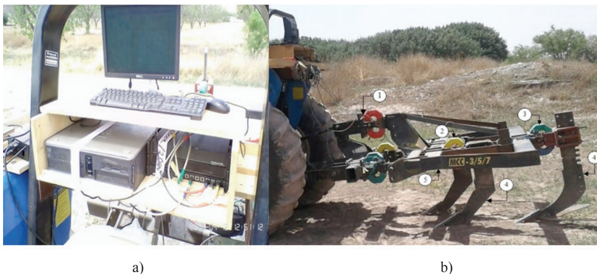
Figura 2. a) Sistema de adquisición de datos montado sobre el tractor. b) Agregado tractor-arado de cincelos instrumentado: con dos octagonales de doble anillo (amarillo, verde) [1] sensores octagonales de referencia [2] y [3], cincelos de roturación [4] y bastidor [5].
