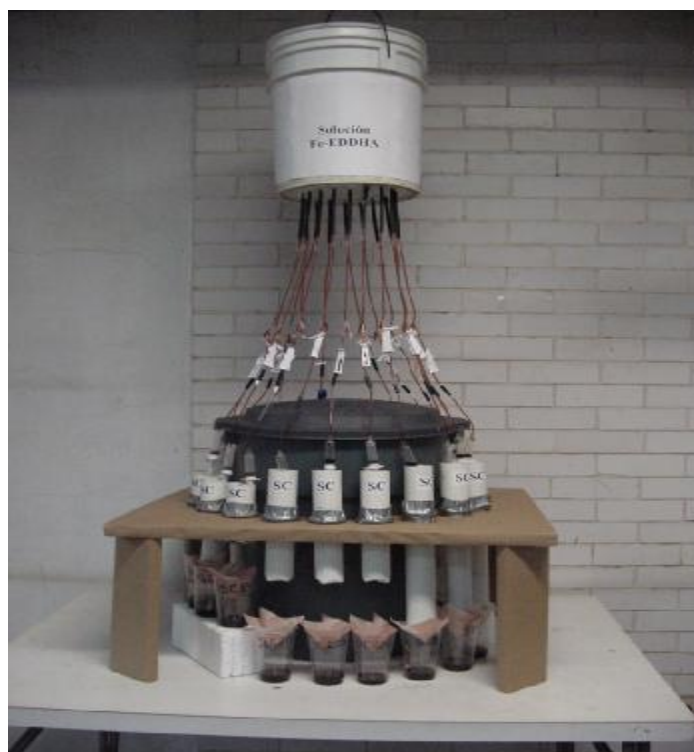
Figura 1. Dispositivo dosificador de soluciones de hierro y agua, aplicadas por goteo sobre columnas de suelo.
