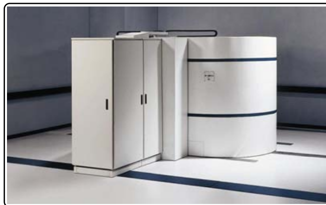
Figura 6. Vista panorámica del acelerador de partículas tipo ciclotrón (RDS 111 de 11 MeV).
