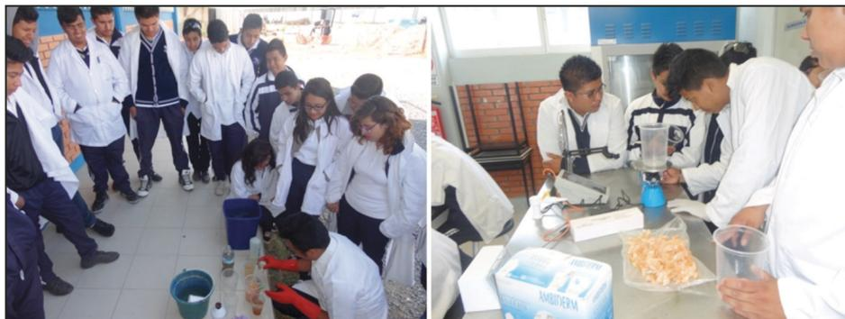
Los alumnos pesaron en la balanza los exoesqueletos de camarón; midieron 3 ml de ácido muriático utilizando una pipeta y con el auxilio del agitador magnético se mezcló por espacio de 5 minutos. Este procedimiento se replicó tres veces.
