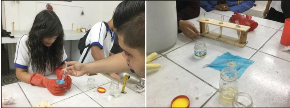
En la Foto 2 los alumnos están llevando a cabo la filtración de los residuos de exoesqueletos de camarón usando utensilios caseros como frascos, jeringas y tela. Se aprecia además en el lado derecho de la imagen una gradilla de madera que fue construida por los propios alumnos.
