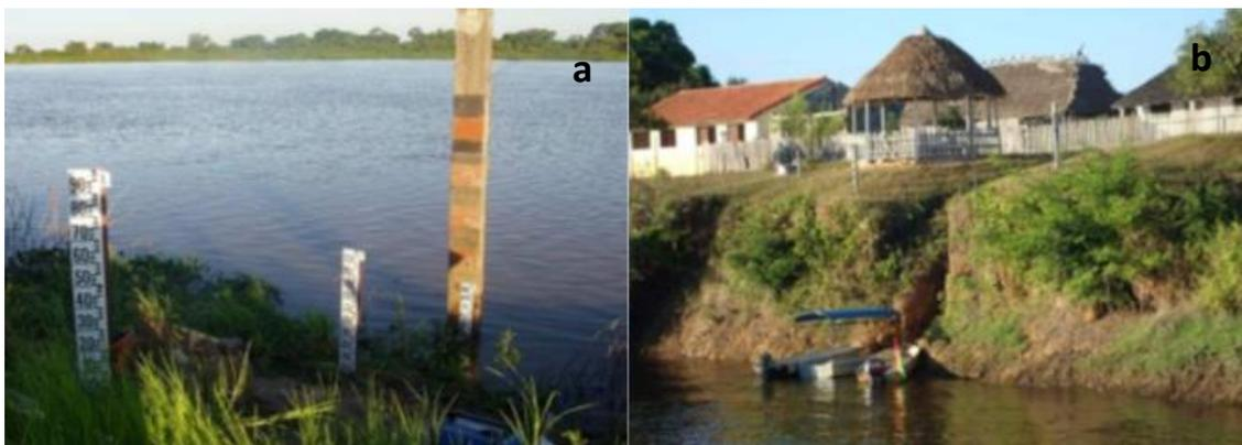
**Figura 3.** Tipos de estaciones hidrométricas: a) con limnímetros escalonados en puerto Busch, río Paraguay; b) referencia nivel barranco en Versailles, río Iténez. Fuente: SNHN.
