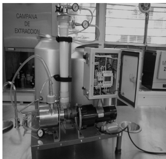
Figura 1. Equipo de filtración de membranas, escala piloto.
