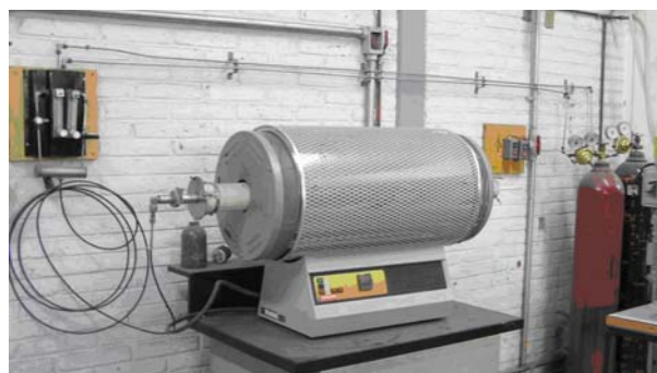
Figura 2. Horno Tubular empleado en los experimentos de unión.
