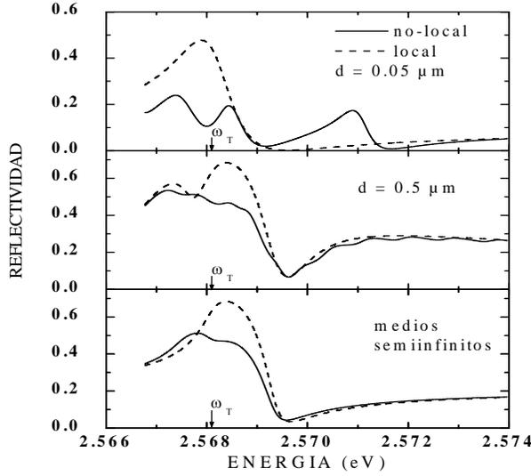
**Figura 5.** Curvas de reflectividad para la transición excitónica  $B_{n=1}$  para diferentes espesores  $d$  de las placas semiconductoras. Los efectos importantes de las transiciones se dan en la vecindad de la energía del excitón  $\hbar\omega_T$ . Se comparan los espectros de reflectividad para el caso no local ( $\epsilon = \epsilon(\omega, q)$ ) y local ( $\epsilon = \epsilon(\omega)$ ).
