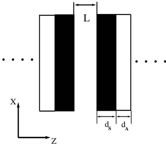
**Figura 2.** Geometría del sistema para el caso placas inhomogéneas formadas por superredes semiinfinitas con celda unitaria semiconductor-aislante. La capa semiconductora tiene una función dieléctrica no local  $\varepsilon_S(\omega, q)$  y el aislante una local  $\varepsilon_A(\omega)$ . El periodo de la superred es  $d = d_s + d_A$ .
