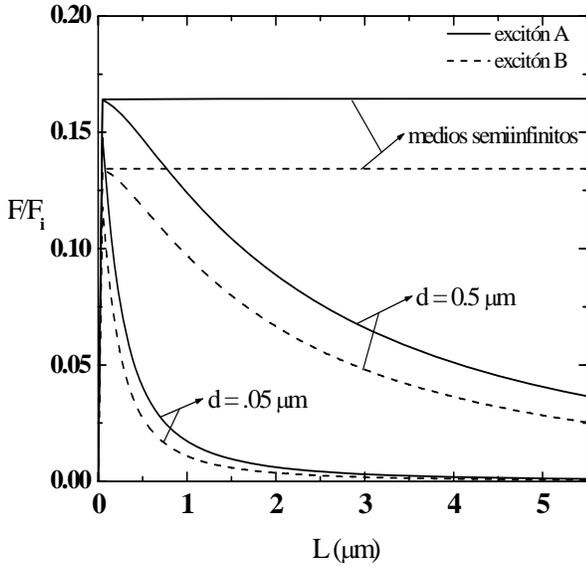
**Figura 3.** Fuerza de Casimir como una función del ancho de la brecha de vacío  $L$  y los espesores de las placas  $d = 0.05 \mu\text{m}$ ,  $d = 0.5 \mu\text{m}$  y medios semiinfinitos ( $d \rightarrow \infty$ ); tomando en cuenta las transiciones excitónicas. Las líneas continuas representan la fuerza de Casimir del excitón  $A_{n=1}$  y las discontinuas las del excitón  $B_{n=1}$ .
