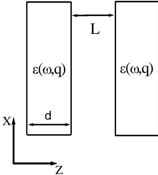
**Figura 1.** Representación esquemática del sistema placas paralelas de espesor  $d$  que se describen a través de la función dieléctrica  $\varepsilon(\omega, q)$ . Una región de vacío de ancho  $L$  separa las placas.
