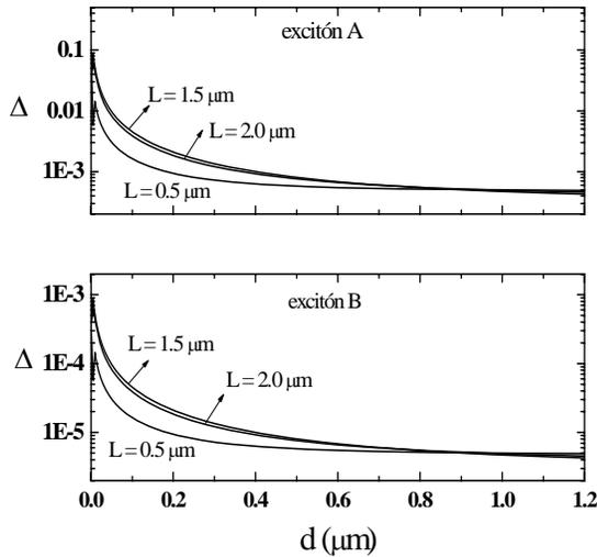
**Figura 4.** Comparación de la fuerza de Casimir local y no local para los dos tipos de transición excitónica a través de  $\Delta = (F_{loc} - F_{nloc}) / F_{nloc}$  como una función del espesor de las placas  $d$  y para tres anchos de separación  $L$  entre ellas. Se observa una mayor diferencia en el valor de las fuerza para espesores delgados de las placas.
