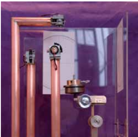
Figura 1. Aparato empleado para la medición de superficies dentales a través de goniómetros y luz láser (patente 264310).
