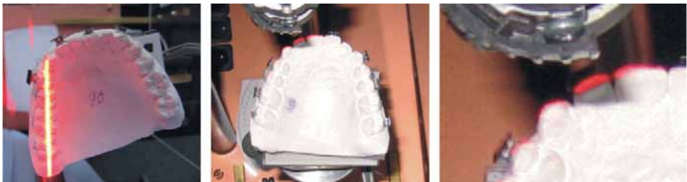
Figura 7. Orientación de la luz láser sobre el surco oclusal de los dientes posteriores y bordes incisales.
