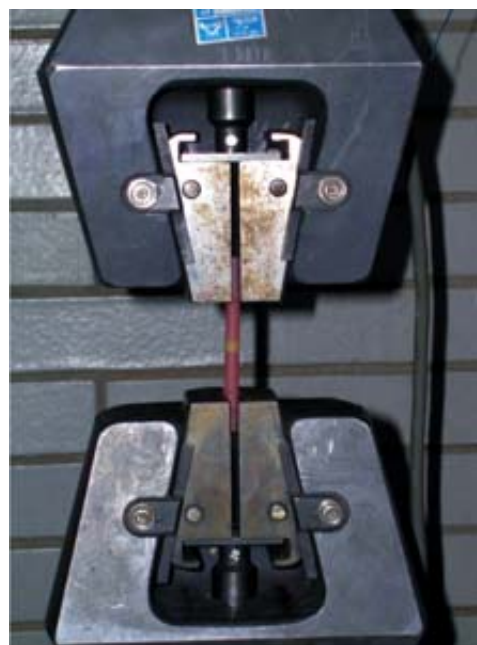
Figura 4. Muestra de resina acrílica para bases de dentaduras con diente de resina acrílica incluido en ella. Prueba de fuerza de unión en la Máquina Universal de Pruebas INSTRON.
