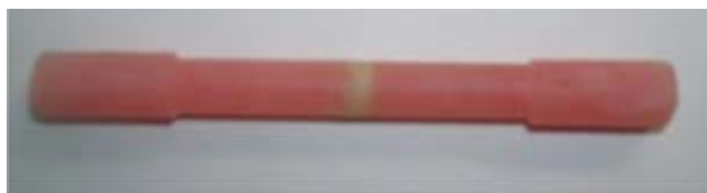
Figura 2. Muestra preparada con torno de acuerdo a las dimensiones especificadas por la Norma no. 15 de la ADA.
