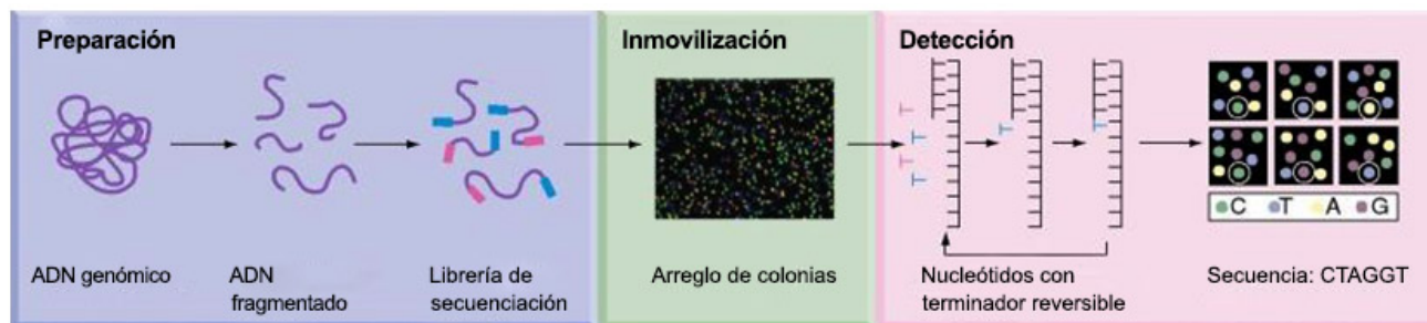
Figura 1. Flujo de trabajo de las tecnologías NGS: Preparación de las muestras, inmovilización y detección. Fuente: Referencia (9).
